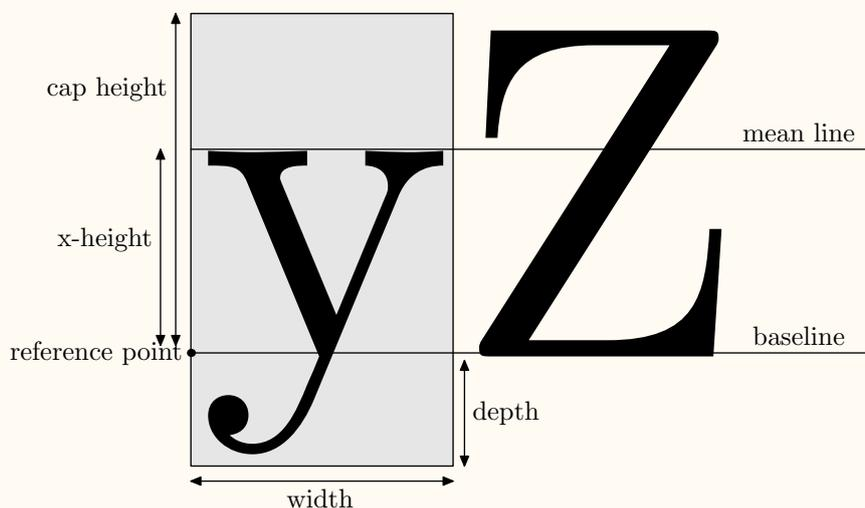
這個超出基線以下的長度，我們稱之爲深度 (depth)，以上的就稱爲字高 (height)，當然大小寫的不同又分爲大寫字母的字高 (cap height) 及小寫字母 x 的字高 (x-height)，由於這個例子裡是調合字，所以每個字的寬度 (width) 不一定會一樣，像打字機字族的則是等寬的字型。字高加上深度，我們就稱之爲 totalheight，大部份的情況，僅僅說 height 時是不包括 depth 的，而且通常指的是 cap height。
